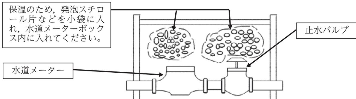
凍結して給水管が破裂したときは、バルブに表示された方向へ回して止水し、指定事業者へ連絡してください。バルブを回すと、途中でバルブ本体から水が出ます。開閉とも、途中で止めないで最後まで回してください。
