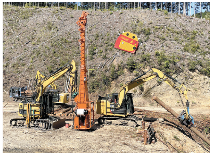
▲最先端的林業機械(アタッチメント式タワーと自走搬器)を使用した架線作業現場
