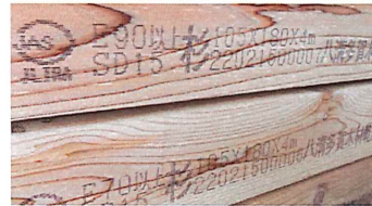
等級は含水率と強度の測定により決まる。表示等級の数字が大きいほど強く曲がりにくい。
