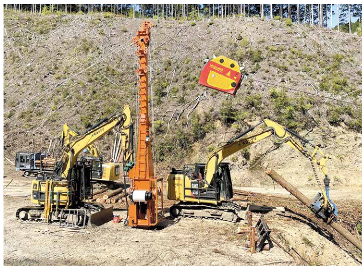
▲最先端的林業機械(アタッチメント式タワーと自走搬器)を使用した架線作業現場
