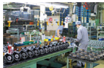
▲ピストンポンプ組立製造ライン
