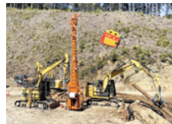
▲最先端の林業機械(アタッチメント式タワーと自走搬送機)を使用した架線作業現場
