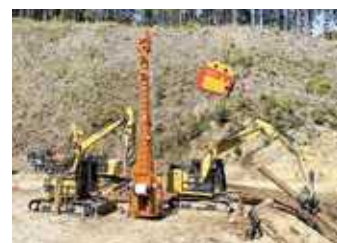
▲最先端の林業機械(アタッチメント式タワーと自走搬送器)を使用した架線作業現場
